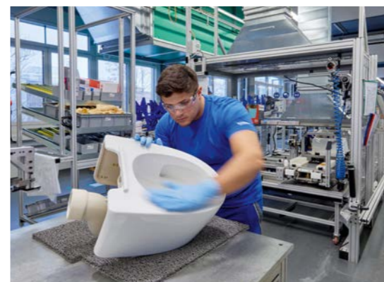
Montáž sprchovacích WC...
