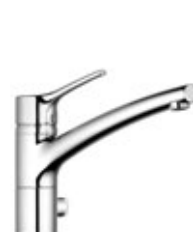
33 57 905 75 drezová bajonetová jednopáková batéria s multipripojkou pre montáž pod okno otočný výtok (360°) pripojka pre práčku a umývačku riadu H1 206, H2 154, A 217, Ø1 34, Ø2 52
