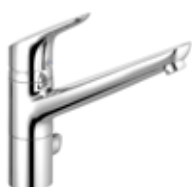
32 579 05 75 drezová bajonetová jednopaková batéria s multiprípojkou otočný výtok (360°) pre montáž pod okno, prípojka pre práčku a umývačku riadu H1 213, H2 172, A 203, Ø1 34, Ø2 52
