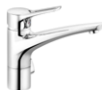
39 907 05 62 drezová jednopáková batéria s multipripojkou otočný výtok (360°) pripojka pre práčku a umývačku riadu pre beztlakový prietokový ohrievač
