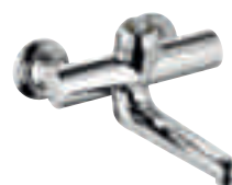
33 533 05 00 umývadlová jednopáková batéria možnosť voľby Klinik- alebo Public-pákovkej rukoväte keramická kartuša s poistkou proti obareniu otočný alebo pevný výtok
