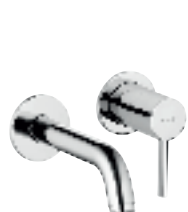
38 244 05 76 podomietková umývadlová dvojtvorová nástenná jednopáková batéria vyloženie 180 mm 38 245 05 76* vyloženie 230 mm 38 243* montážny set
