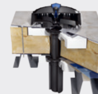
↓ Zateplená strecha s ľahkou konštrukciou vybavená hydroizolačnou fóliou
