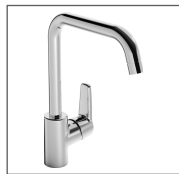
HANSAPOLO jednotvorová páková baterie pro dřez, DN 15 5156 2293 chrom připojení pomocí tlakových hadic vyložení: 203 mm
